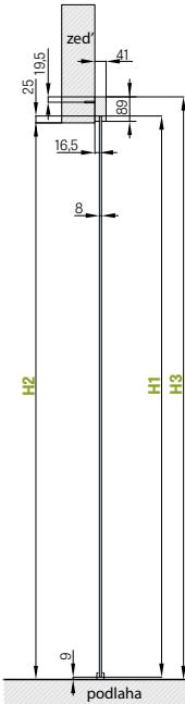
Posuvný systém na stěnu pro skleněné dveře s hliníkovou garnýží ve stříbrné barvě. Systém je kompletní a je určen pro začištěný průchozí otvor, nelze ho doplnit zárubní - tunelem. V systému jsou dostupné všechny skleněné modely dveří GRAF.
