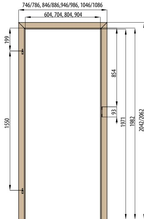
■ Ostění pro rozšíření tloušťky zárubní
