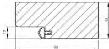
Rámové zárubně se dodává v delším provedení. Je třeba zkratit na místě na požadovaný rozměr.
