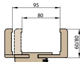
Pro zárubně regulace s regulací 80-95 je třeba svépomocí seříznout krycí lištu dle přesné tloušťky zdi
