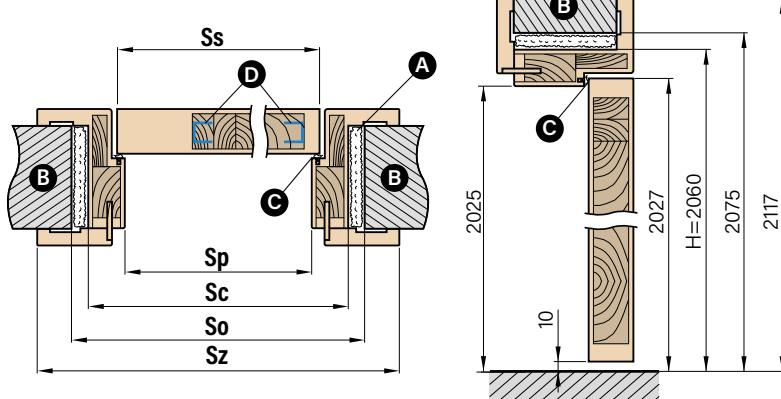
A – montážní pěna    B – zeď    C – těsnění    D – ocelový profil tvaru „C“
