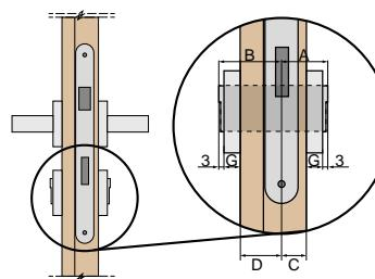
Příklad výpočtu cylindrické vložky při tloušťce rozety kování  $G = 7 \text{ mm}$
