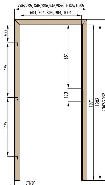
OBLOŽKOVÁ ZÁRUBNĚ TYPU TUNEL (SLEPÁ)
